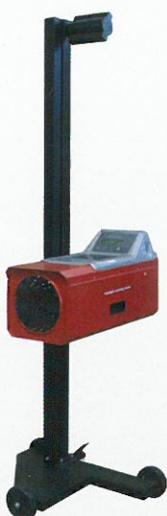
**Cyclope Advanced level (453-L1\* e 453-L2\*)** è la linea centrafari multimarca per il controllo e la determinazione dell'orientamento e dell'intensità luminosa emessa dai proiettori degli autoveicoli e dei mezzi pesanti posti secondo le indicazioni del costruttore, ad una distanza prefissata di circa 30 cm. Le apparecchiature sono facili da usare e di semplice lettura.
